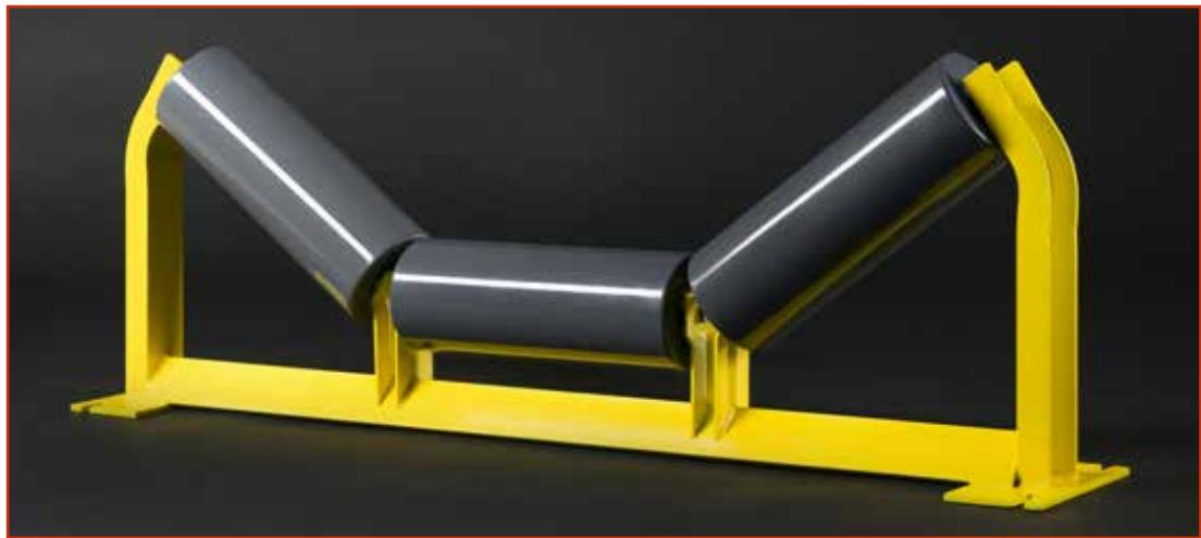
Come quelle illustrate nelle pagine precedenti, queste traverse hanno una forma autopulente ottenuta con una trave angolare con il vertice in alto e con i supporti laterali sagomati con un profilo che si allontana dalle testate dei rulli.
