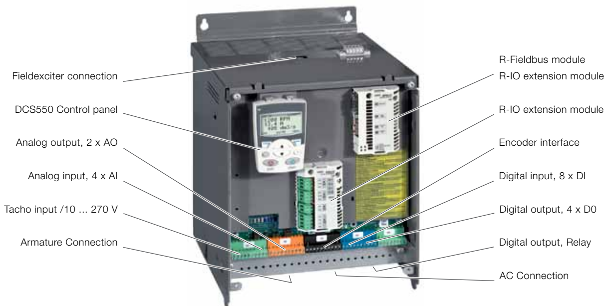
DCS550 converter module
